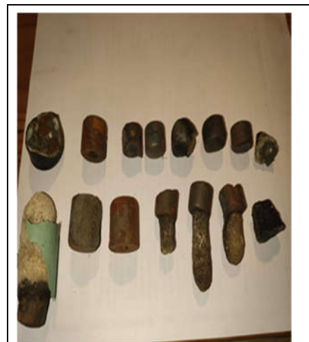
Figure 16 : Grosses pièces métalliques retrouvées sur les aimants ( de 2 cm à 8 cm)
