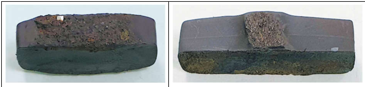
Figure 51 : Deux exemples d'aimants en gros plan présentant à la fois des signes de dissolution et de dépôts solides qui semblent soudés aux aimants (gangue).
