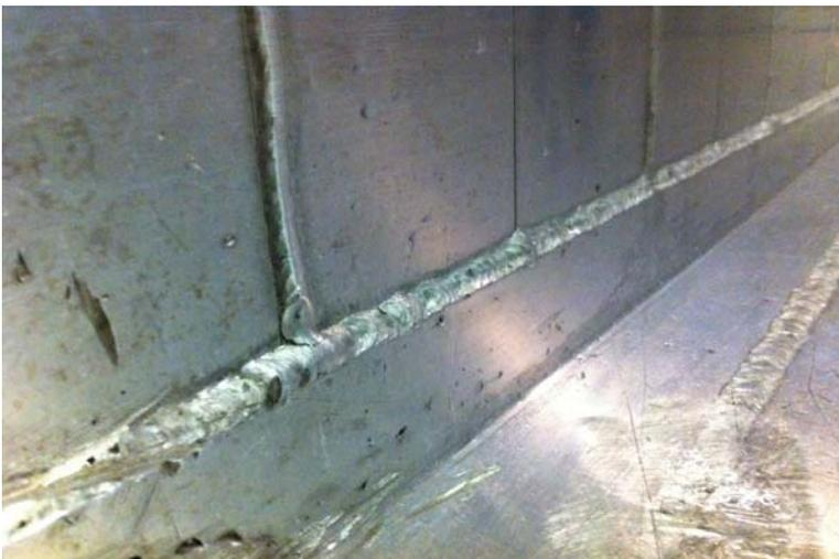
Photo 1 : zones de rugosité à l'intérieur de la benne (après nettoyage des surfaces)
