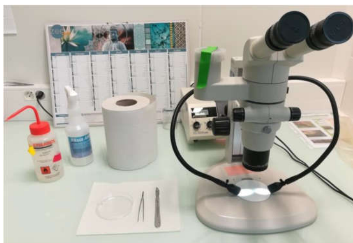
Figure 2 – Photo du matériel nécessaire à l'ablation de la tête d'insecte (Source: A. Dintheer LSV Angers, 2018)
