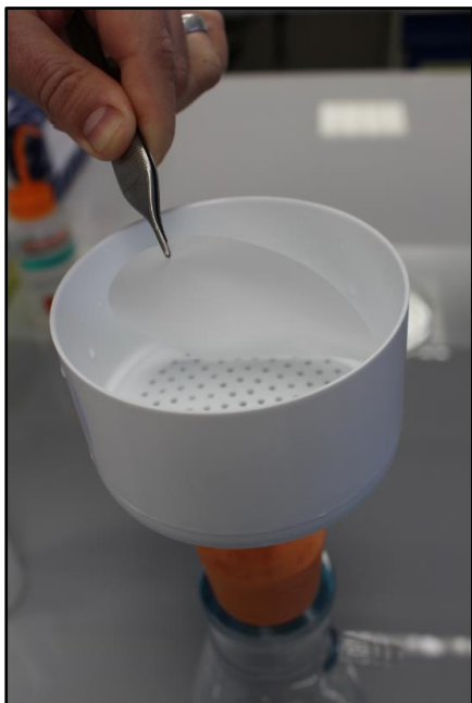
Figure 4 : Installation d'un filtre à 60 µm, qui sera suivi d'un rinçage à la pissette d'eau osmosée, pour lui permettre de bien adhérer au porte filtre.
